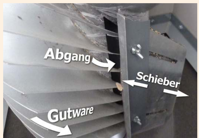
Abbildung 4: Das Ende der achtfachen „Murmeltbahn“: Mittels Schieber wird die Trennung in Abgang und Gutware justiert.
