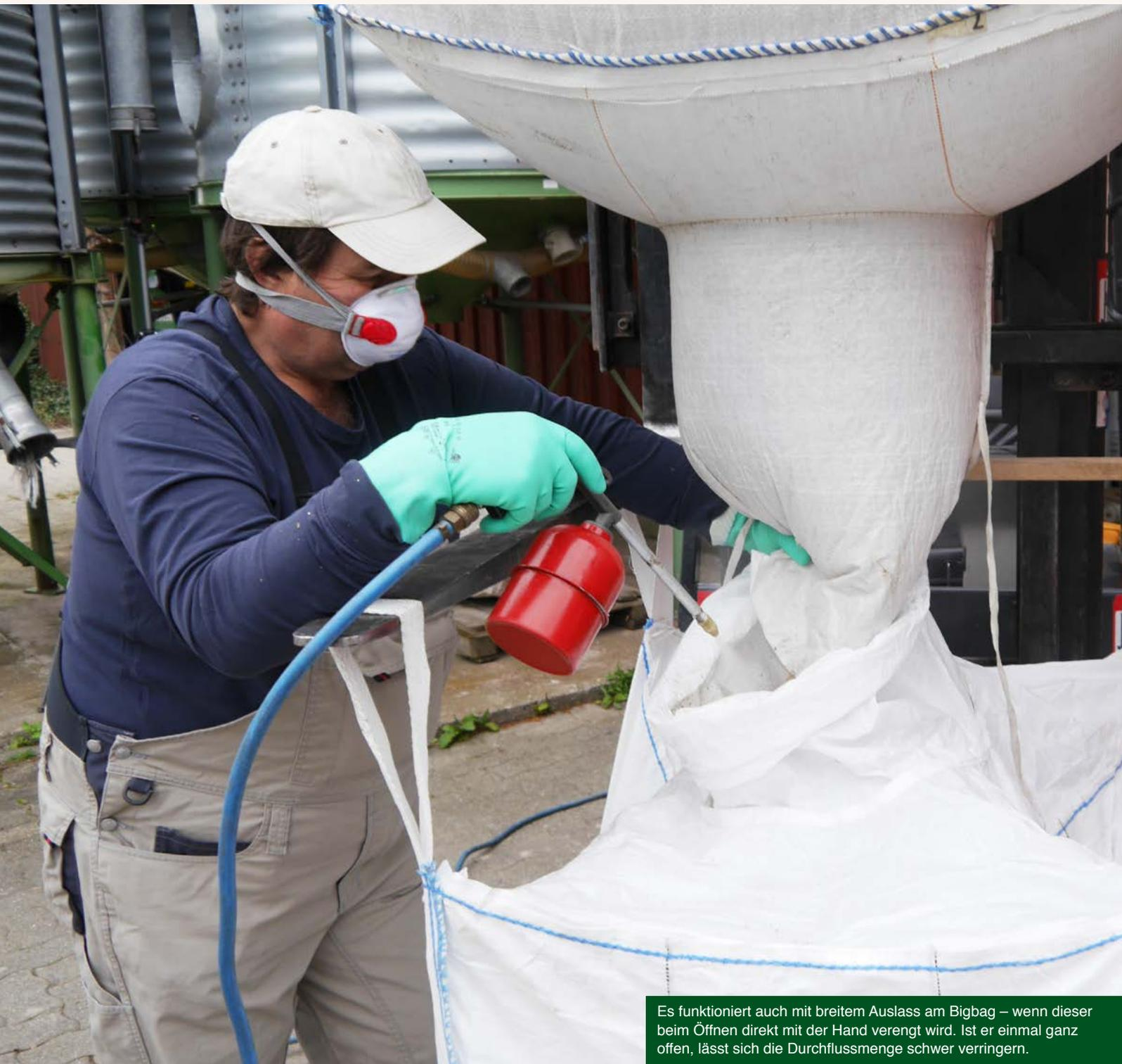
Es funktioniert auch mit breitem Auslass am Bigbag – wenn dieser beim Öffnen direkt mit der Hand verengt wird. Ist er einmal ganz offen, lässt sich die Durchflussmenge schwer verringern.
