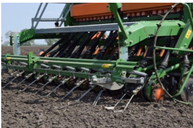
Зерновая сеялка Amazon с гравитационным механизмом дозирования/подачи семян обеспечивает ширину междурядий 150 мм. Фотография: Donau Soja
