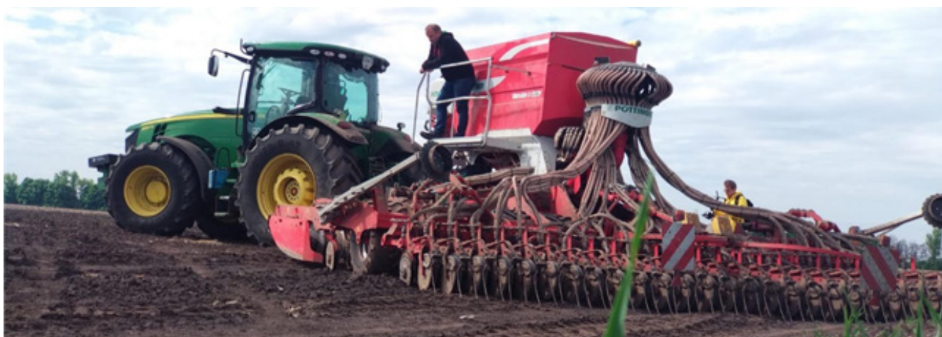
Зерновой высевающий комплекс Pöttinger с пневматическим механизмом дозирования/транспортировки семян обеспечивает ширину междурядий 125/167 мм или 250 мм. Фотография: Мукoла Вукoв (Donau Soja)
