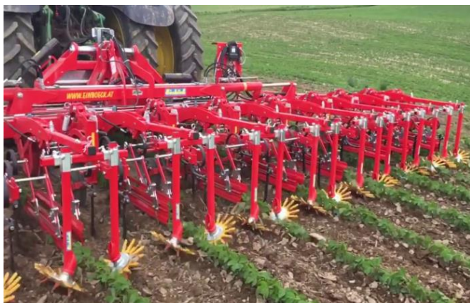
Fig. 3. Combaterea mecanică a buruienilor cu grapa rotativă.
